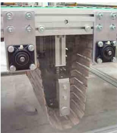
Il tensionamento permette, dove necessita, di tensionare la catena con un sistema meccanico a molla. Il sistema è completo di alberi, pignoni, rinvii e piastre.
