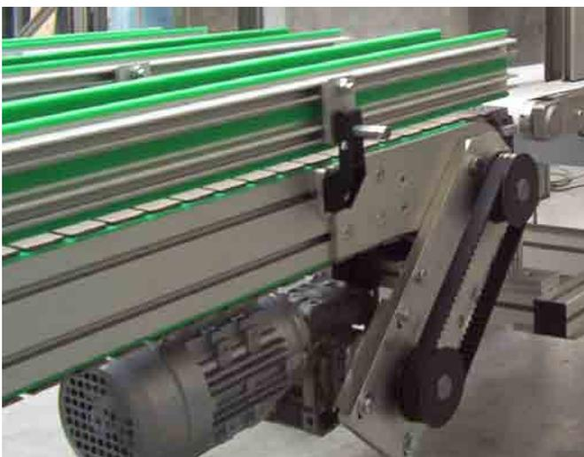
La testata è completa di alberi, cuscinetti, pulegge e cinghia, o catena e pignoni; piastra tendcinghia o tendcatena; carter di protezione. Può essere montata con uscita a destra o a sinistra per la predisposizione di un motoriduttore Bonfiglioli.
